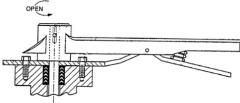
FIGURE 6. LEVER ACTUATOR
