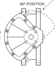
TYPICAL VANE TYPE ACTUATOR
