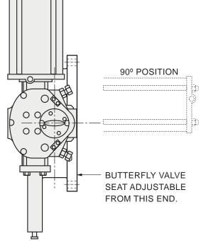
TYPICAL PCA WITH SEPARATE LEVER HOUSING
